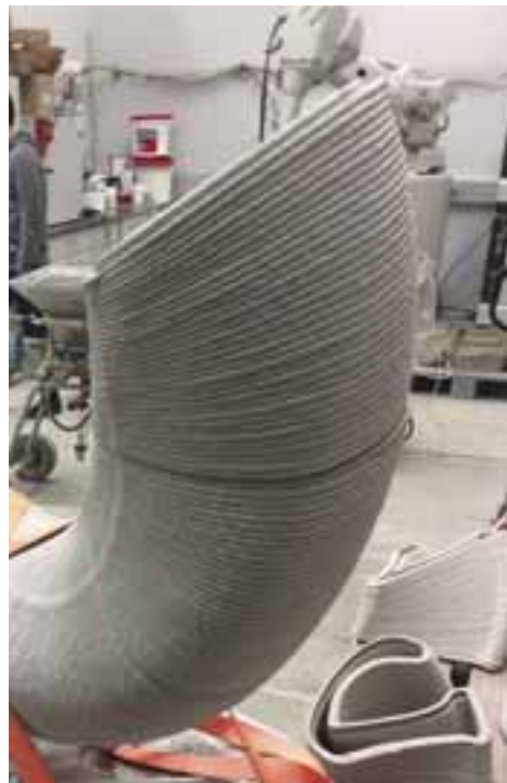
Oben: Produktion des Objektes „on“ im 3D-Druck-Verfahren mit Beton („BauMinator®“) in der Entwicklungsabteilung der Baumit GmbH
